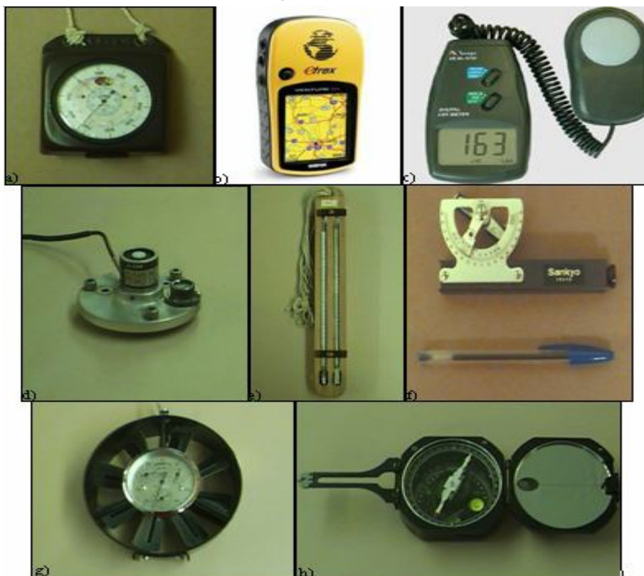
Figura 1: Instrumentos utilizados no trabalho de campo: a) altímetro barométrico, b) GPS, c) luxímetro, d) radiômetro, e) psicrômetro (termômetro de bulbo seco e úmido), f) clinômetro, g) anemômetro e h) bússola.
